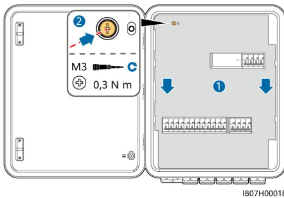
**Schritt 2** Bevor Sie die Tür des Wartungsfachs schließen, schalten Sie die vier in der folgenden Abbildung dargestellten Schalter ein (am Beispiel des Anschlusses von drei parallelen MAP0-Wechselrichtern).
