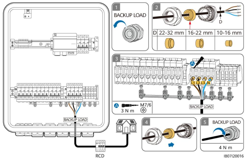
Abbildung 5-20 Anschließen des Ausgangstromkabels der Backup-Last (TN-C-System)
