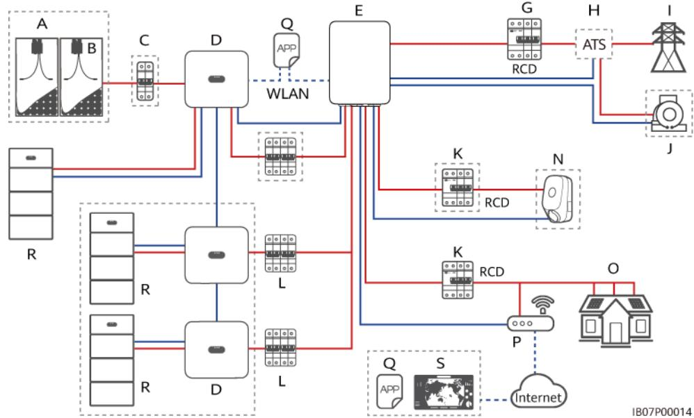
**Abbildung 2-6** Vernetzung einiger Lasten, die an die SmartGuard angeschlossen sind (gestrichelte Kästchen weisen auf optionale Komponenten hin)
