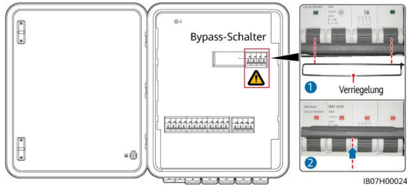
**Schritt 3** Schalten Sie die vier in der folgenden Abbildung dargestellten Schalter ein. (am Beispiel des Anschlusses von drei parallelen MAP0-Wechselrichtern).
