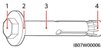
(1) Sechskantschraube      (2) Flache Unterlegscheibe      (3) Hülse      (4) Konische Mutter
