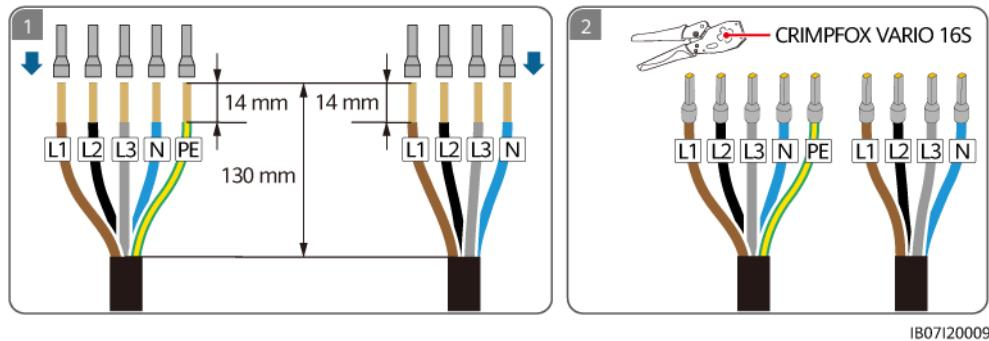
**Schritt 4** Schließen Sie die AC-Eingangsstromkabel des Wechselrichters an.
