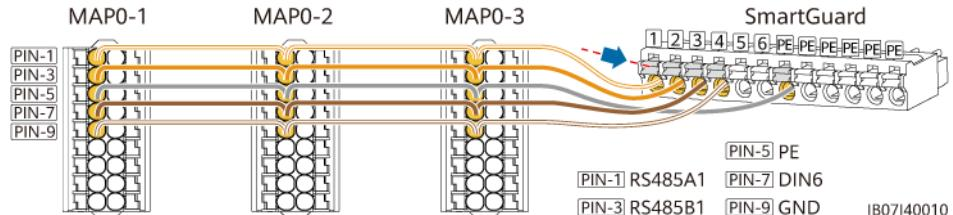
**Schritt 3** Schließen Sie die Signalkabel des SmartGuard an.
