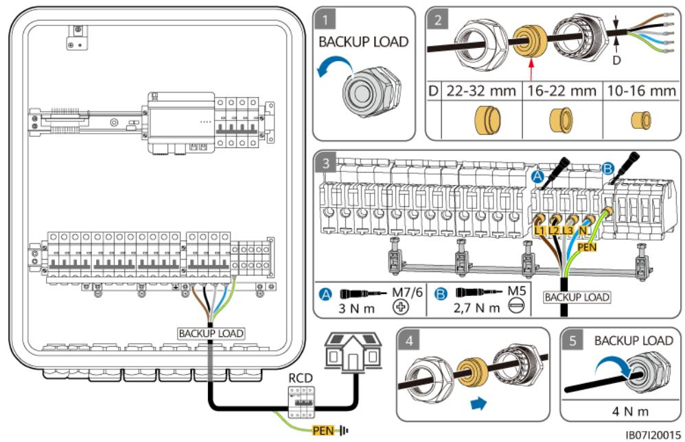
**Abbildung 5-19** Anschließen des Ausgangstromkabels der Backup-Last vom SmartGuard-63A-AUT0 (TN-S/TN-C-S/TT-System)
