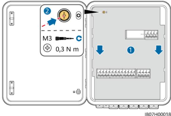
**Schritt 2** Entfernen Sie die Verriegelung des Überbrückungsschalters und schalten Sie den Überbrückungsschalter ein.
