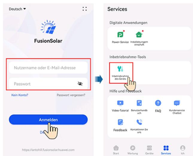
**Schritt 2** Stellen Sie eine Verbindung zum WLAN der EMMA her und melden Sie sich als **Installateur** an, um auf den Bildschirm „Inbetriebnahme des Geräts“ zuzugreifen.
