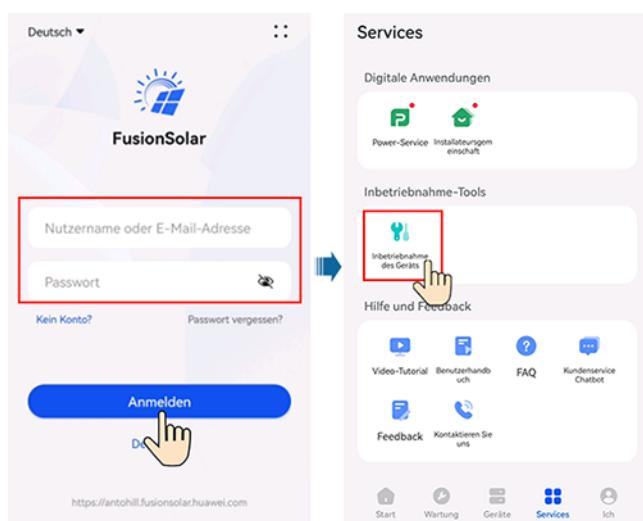
**Schritt 2** Stellen Sie eine Verbindung zum WLAN des Wechselrichters her und melden Sie sich als **Installateur** an, um auf den Bildschirm „Inbetriebnahme des Geräts“ zuzugreifen.
