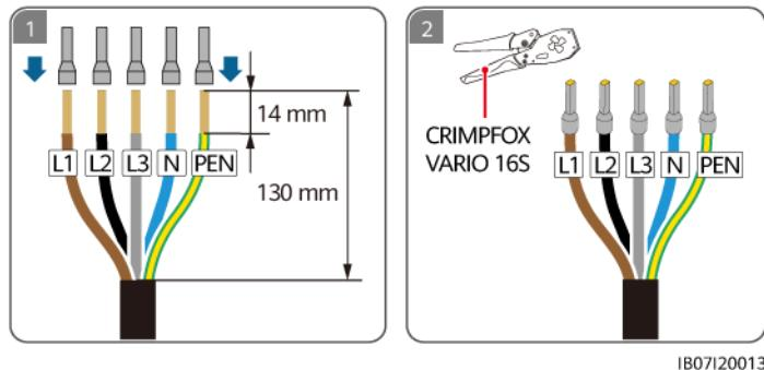
**Abbildung 5-16** Crimpen der AC-Kabelendklemmen für den SmartGuard-63A-AUT0 (TN-S/TN-C-S/TT-System)
