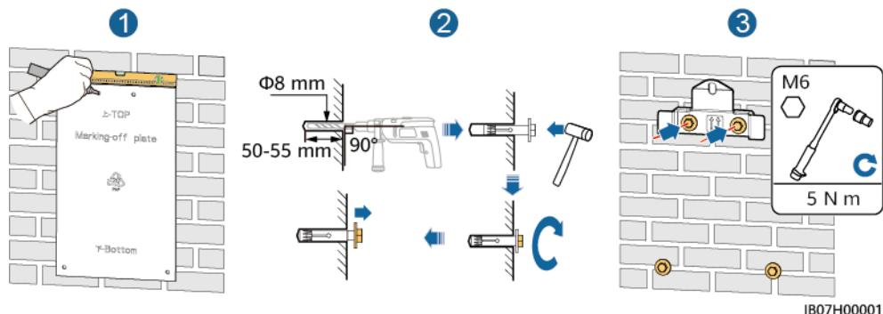
**Schritt 3** Montieren Sie den SmartGuard an der Halterung und ziehen Sie die Muttern fest.
