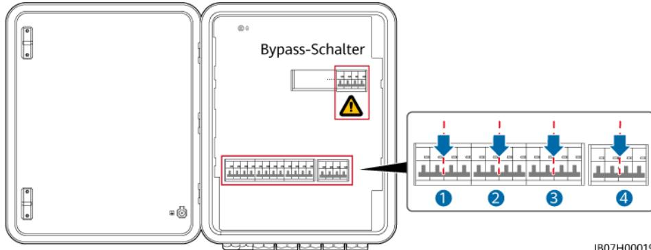
2. Entfernen Sie die Verriegelung des Bypass-Schalters, schalten Sie den Bypass-Schalter ein, und schalten Sie dann die in der Abbildung gezeigten Schalter ③ und ④ ein.
